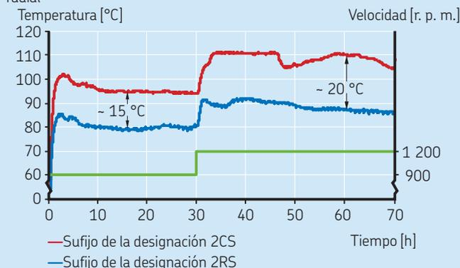
La disminución de la fricción del sello en los rodamientos con rendimiento mejorado (sufijo de la designación RS) resulta en una menor temperatura de funcionamiento, lo que permite prolongar los intervalos de relubricación.
